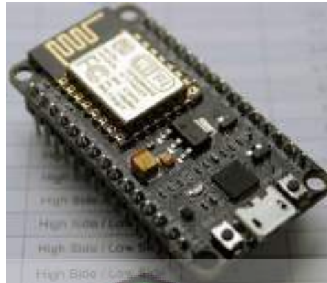
Gambar 3.2 Mikrokontroler ESP8266 jenis NodeMCU Ver.1.0
